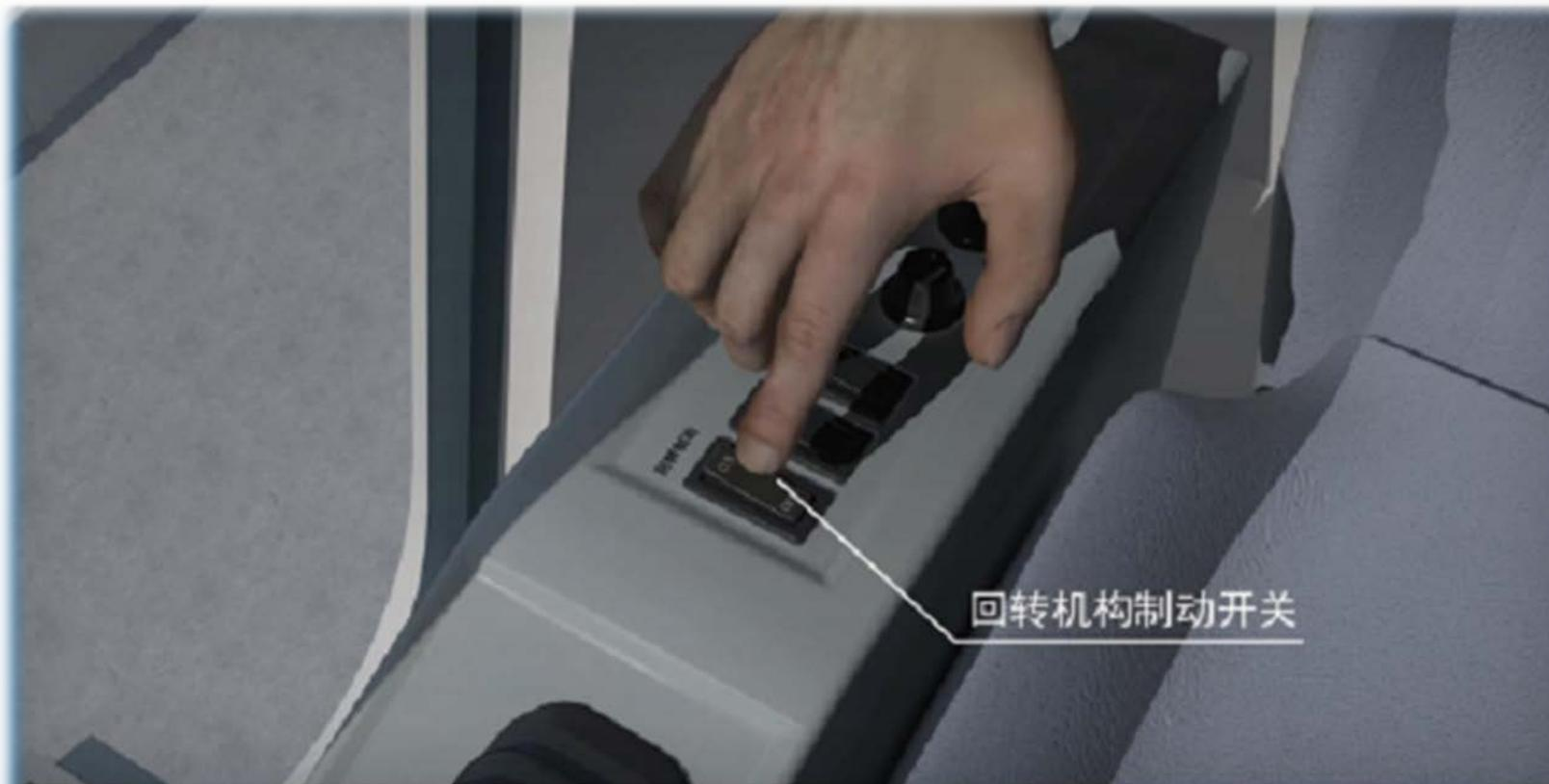
回转机构制动开关
