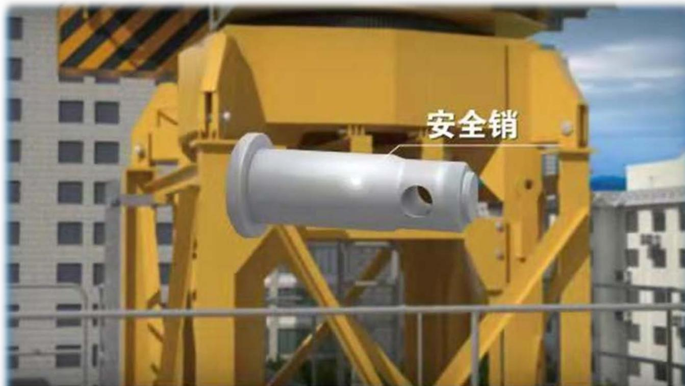
若要连续加节，则每加完1节后，用塔机自身起吊下1节标准节前，塔身各主弦杆和下支座应可靠连接。销轴应使用厂家提供的安全销。
