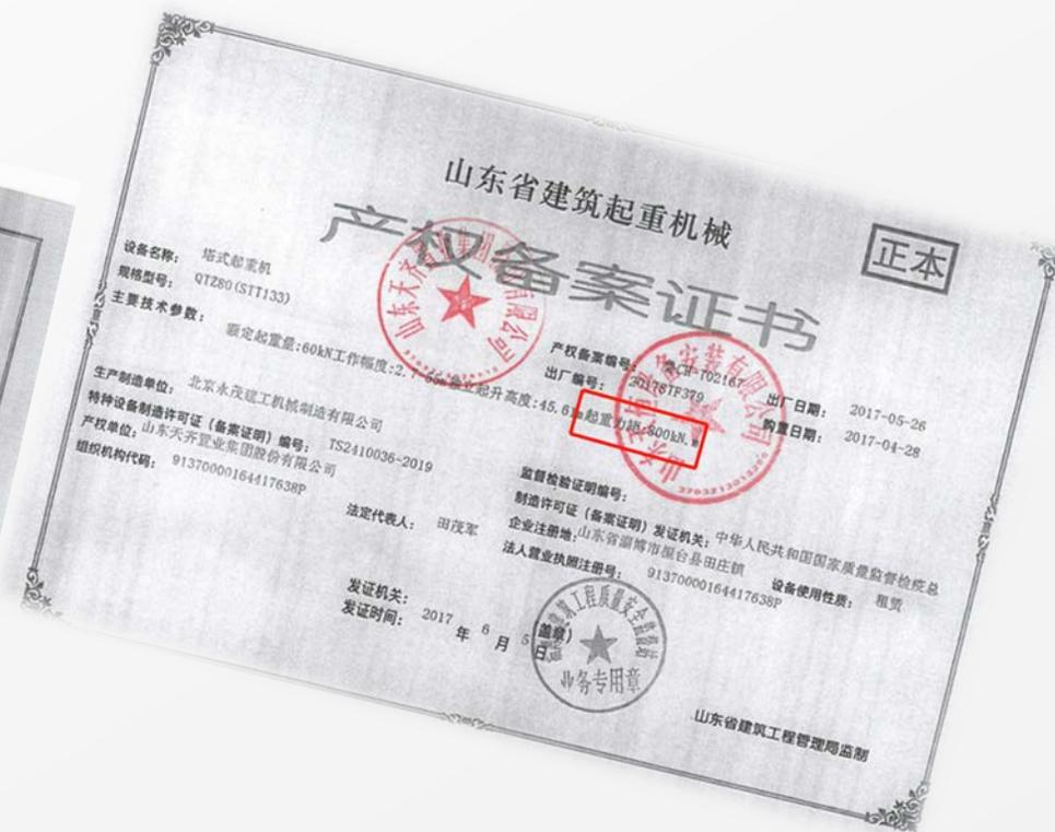
630kN·m以下塔机**严禁**使用，通过备案证、合格证查询，如发现应在选型定位时制止。
