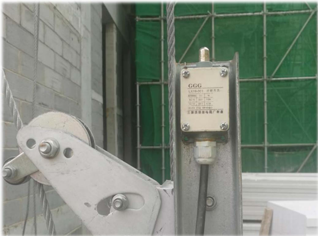
吊篮上限位装置，建议使用U型槽钢固定，降低损坏率
